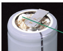
劣化した蓄電池の内部
